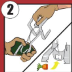
**2** Bestücken Sie die Falle mit einem Köder (z.B. einem Stück Karotte, Kartoffel), indem Sie diesen in das Köderblech einklemmen. Spannen Sie nun durch Zusammendrücken der Griffe die Falle und setzen Sie das Köderblech in der Mitte der Falle ein. Lockern Sie eventuell das Köderblech durch vorsichtiges Hin- und Herbewegen noch ein wenig. Damit wird die Falle sehr empfindlich eingestellt.
