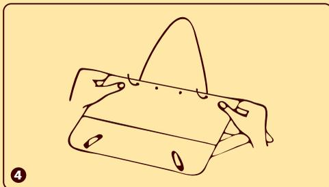
Zum Aufhängen den Draht an der Falle befestigen, indem die Drahtschlaufen durch die mittleren oder äußeren Löcher gesteckt werden. Die Falle an einem Ast, Pfosten oder sonstiger Vorrichtung aufhängen. Am besten zwischen den Bäumen und nicht in den Bäumen.
