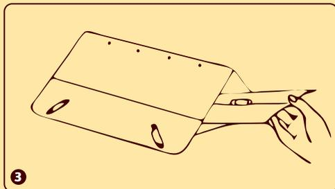
1 Leimboden aus der Folie nehmen und auseinanderklappen. Pheromon-Kapsel aus dem Alu-Beutel nehmen. In die Mitte des Leimbodens legen. Dann den Leimboden an der offenen Seite in die Falle schieben. Die Klappe wie auf der anderen Seite aufstellen.
